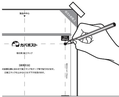
付属の施工マップを取り付ける
