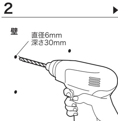
印の箇所にドリルで下穴を開けます。直径6mmのドリルを使用してください。
